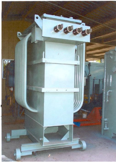
Figura 20: Transformador ONAN
