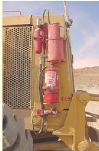
Equipo extintor automático de incendio
