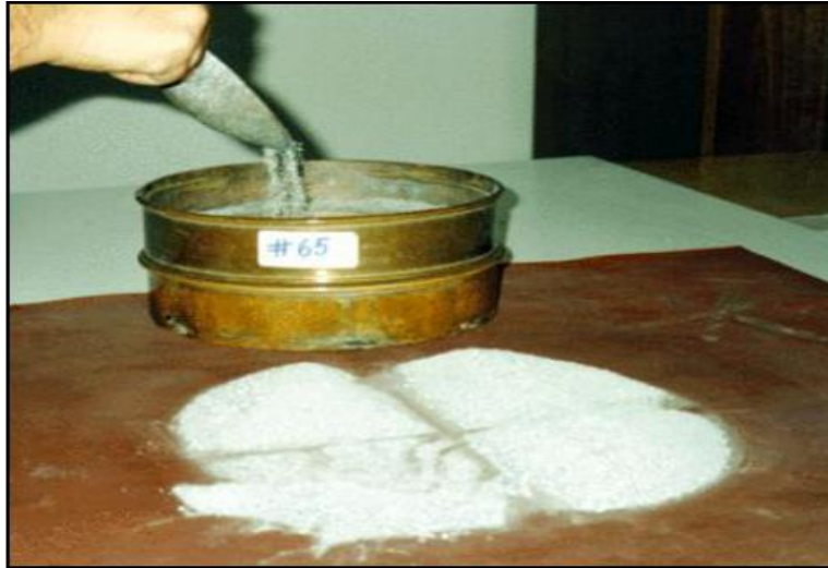
Figura 45 Alimentación de muestras en tamices
