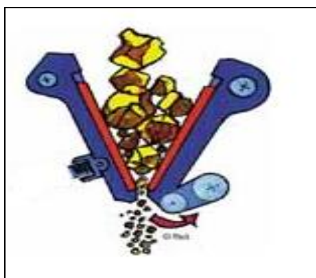
Figura 62 Reducción de tamaño en un chancador de mandíbula
