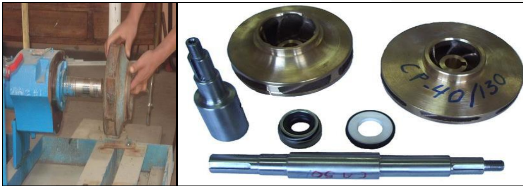
Figura 156 Eje bomba centrífuga.
