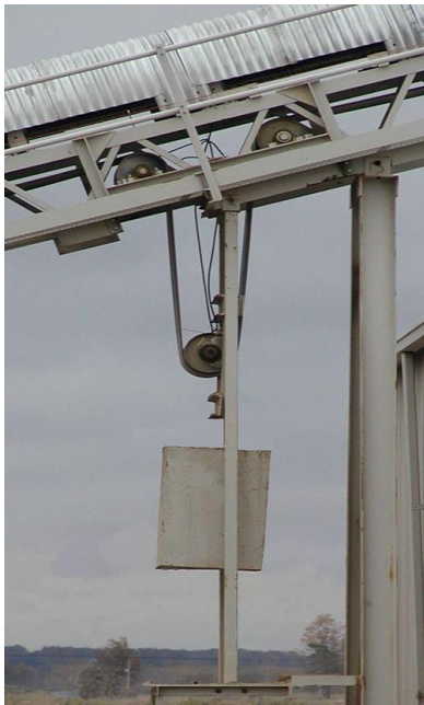
Figura 99 Polea tensora con contrapeso
