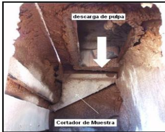
Figura 29 Cortador automático de muestras de pulpa
