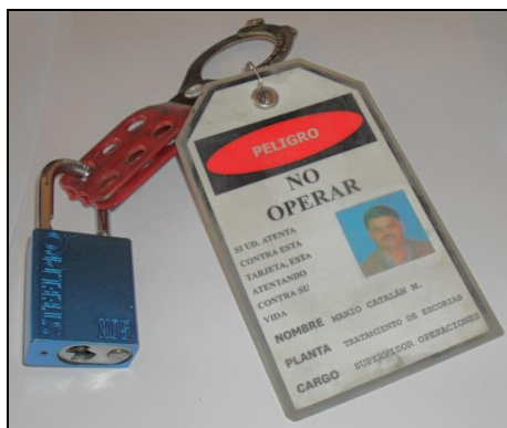
Figura 10 Componentes de un bloqueo
