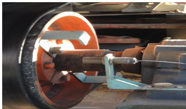
Figura 108 Sensor de velocidad cero
