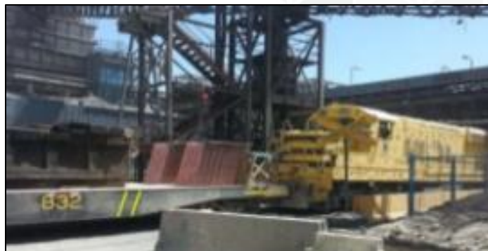
Figura 38. Retiro de ánodos a electro refinación desde cancha de almacenamiento
