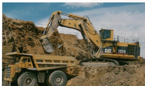
Figura 42: Carga de camiones desde un banco
