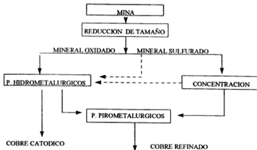
Esquema de procesamiento de minerales de cobre
