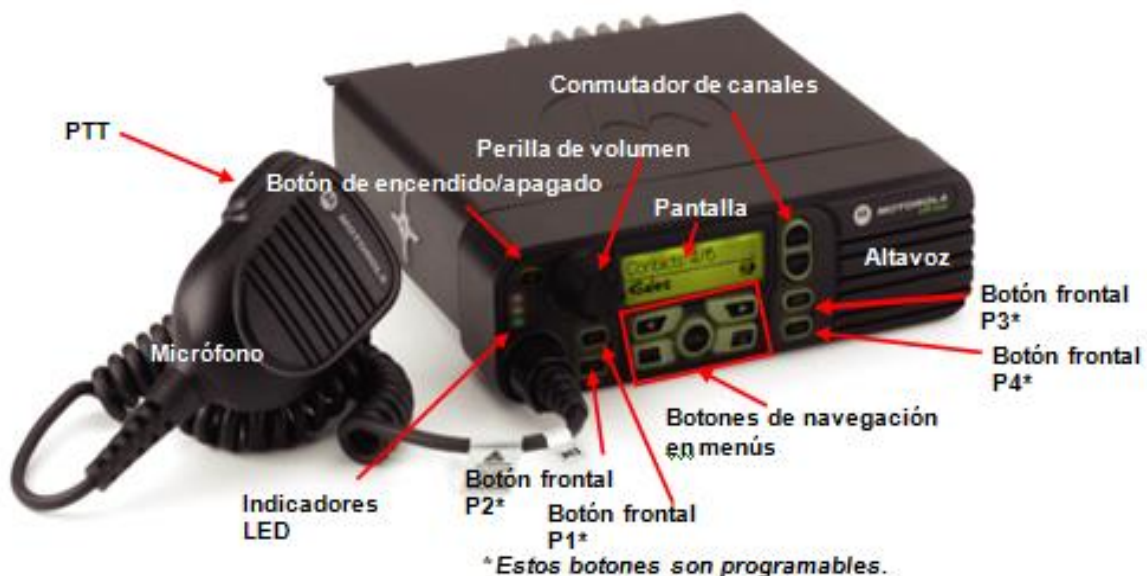
Figura N° 21 Estación Base de la red de comunicaciones
