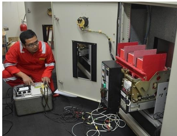
Pruebas de aislación y hipot
