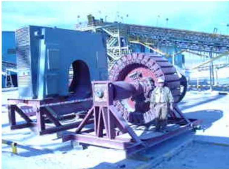
Figura 104 Alternador de polo saliente
