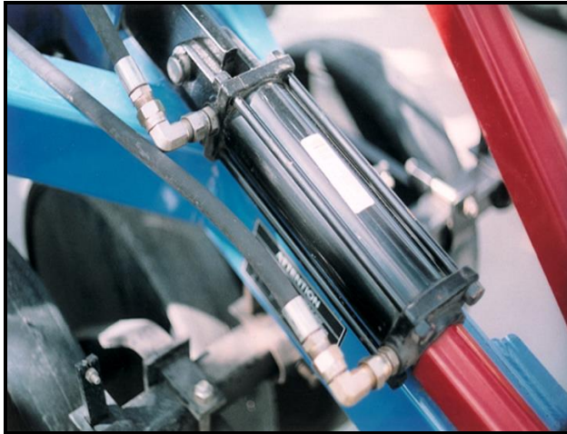
Figura 108: Cilindro con tirante
