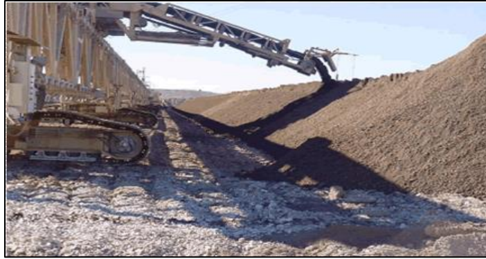
Figura 24 Equipo apilador
