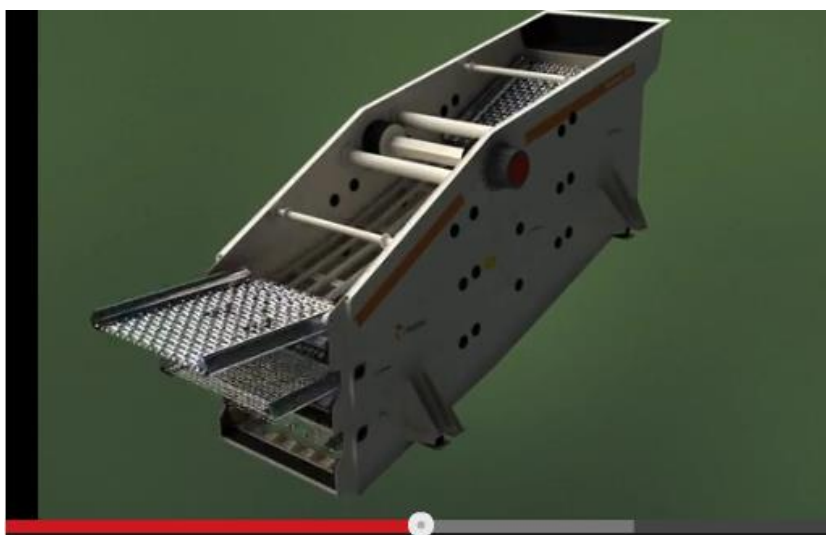
Harnero Vibratorio (Tipos de Cribado)
