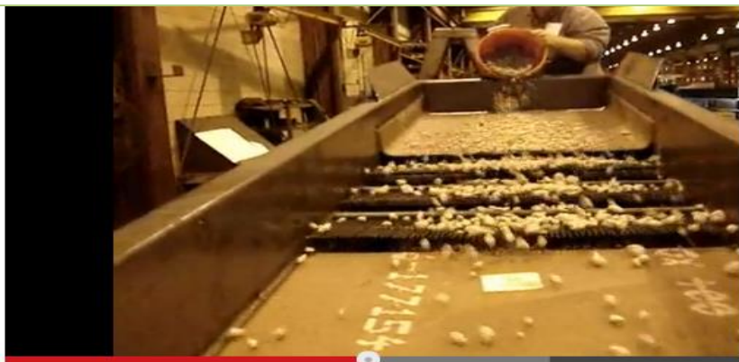
Harnero Vibratorio (Tipos de Cribado)
