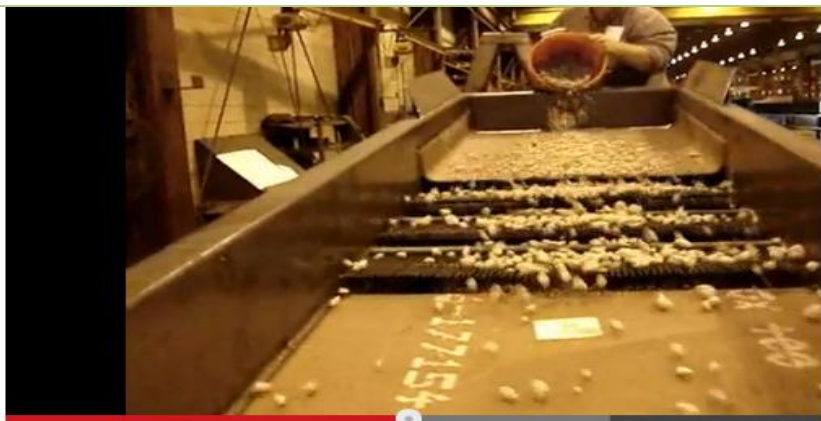
Harnero Vibratorio (Tipos de Cribado)
