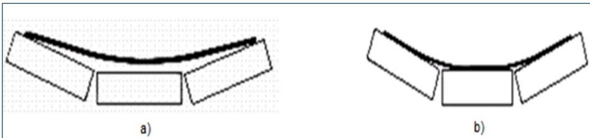
Figura 33a) Cinta tiesa, trabajo inapropiado; b) cinta flexible, trabajo apropiado
